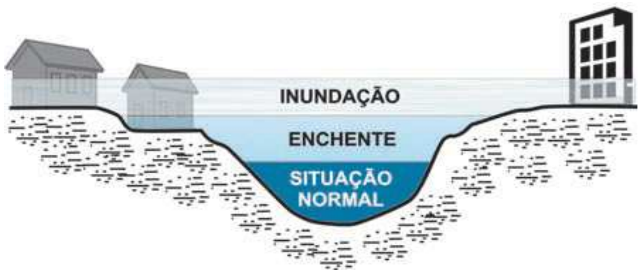
Figura 13. Perfil esquemático do processo de enchente e inundação.
