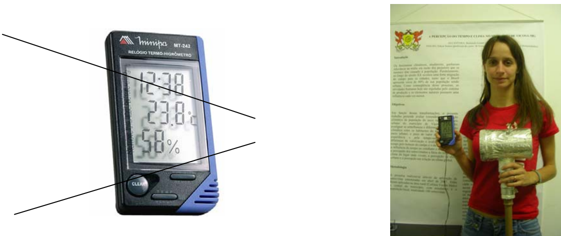
Figura 6. Termohigrometro digital de leitura direta – Modelo Minipa-MT241
