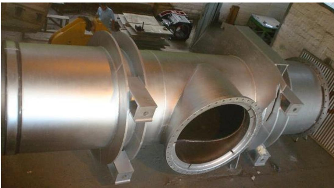
**Figura 8: Segmento de rede de gás diâmetro 2.000mm para Alto Forno de Usinas Siderúrgicas, fabricado pela Esmetal.**
