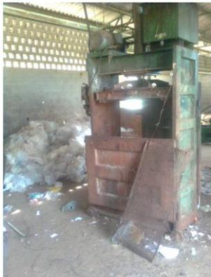
Prensa hidráulica utilizada para enfardar os materiais
