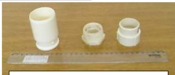
**Figura 11.** Tubos e conexões de PVC
