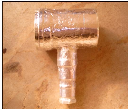
Figura 10. Termohigrômetro associado a encanamento de água recoberto com papel laminado.
