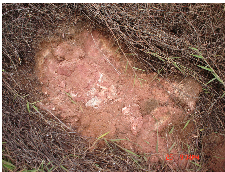
Figura 12. Coleta do torrão no talude situado próximo ao DAH.
