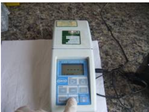
Foto 7 – Fazendo Leitura no Turbidímetro.
