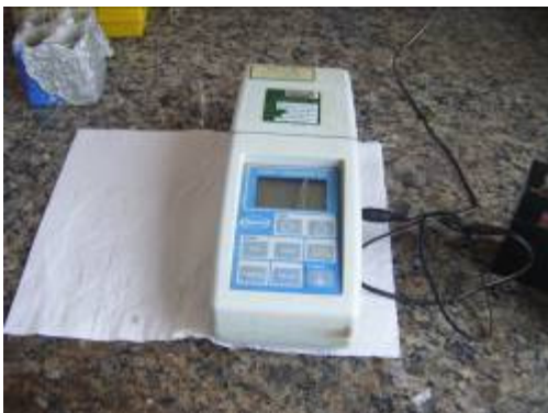
Foto 5 - Turbidímetro Portátil Modelo 2100P da Hach.
