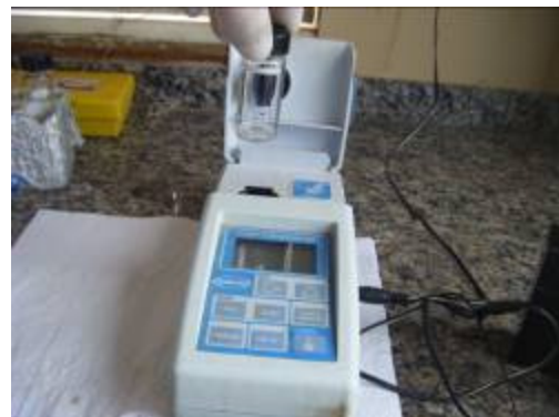
Foto 6 – Frasco de leitura do Turbidímetro.
