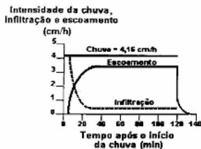
Figura 03 - Intensidade de chuva, taxa de escoamento superficial e capacidade de infiltração para uma chuva artificial de intensidade constante em parcela experimental.
