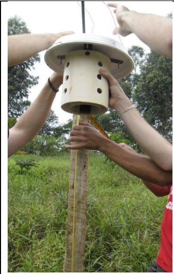
Figura 10: Abrigo instalado e fixado em campo a 1,5 metros em relação ao solo.
