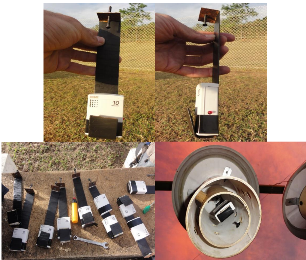
Figura 13: Instalação dos termohigrômetros dataloggers HOBO na Estação Meteorológica da Universidade Federal de Viçosa para aferição.
