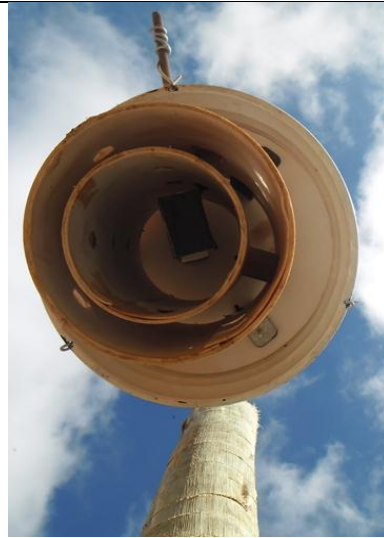
Figura 9: Termohigrômetro instalado no interior do mini-abrigo meteorológico alternativo.
