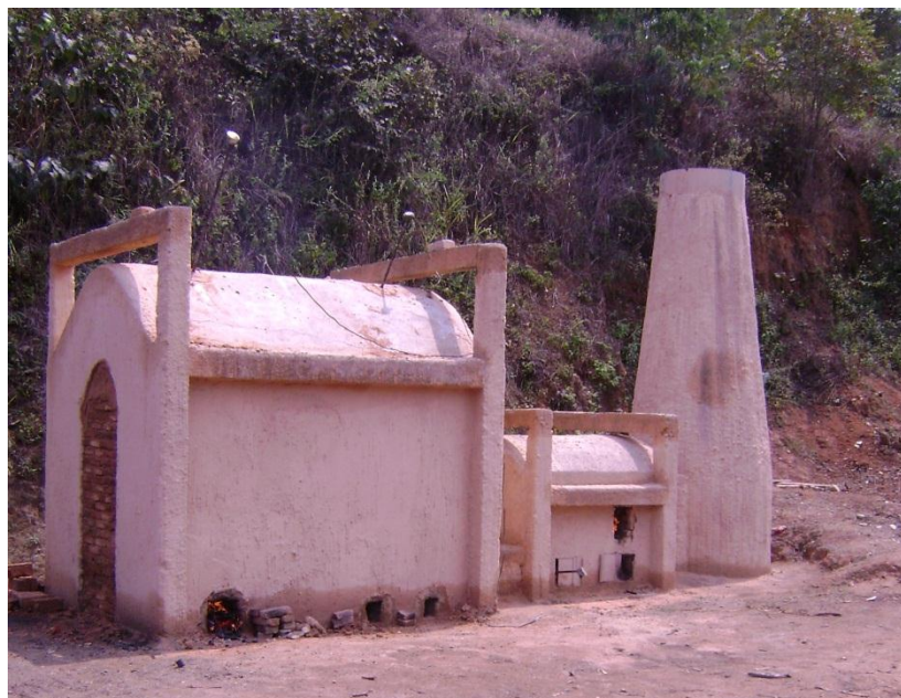
FIGURA 12 – Forno MF1, com sistema de queima de gases (Foto: Autoria Própria, Laboratório de Painéis e Energia da Madeira, 07/01/2012).
