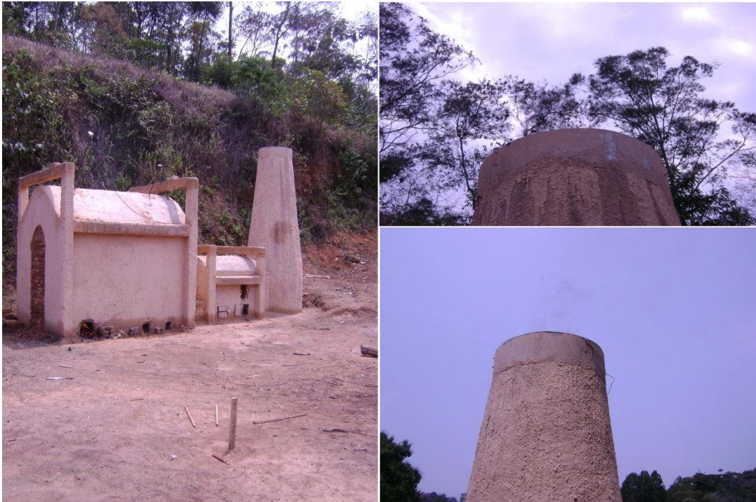
Figura 16 – Forno em processo de carbonização utilizando sistema de queima de gases. A geração de fumaça e particulados é praticamente nula, o que torna o processo um fator de destaque quando comparado aos modelos tradicionais. (Foto: Autoria Própria, Laboratório de Painéis e Energia da Madeira, 15/01/2012)
